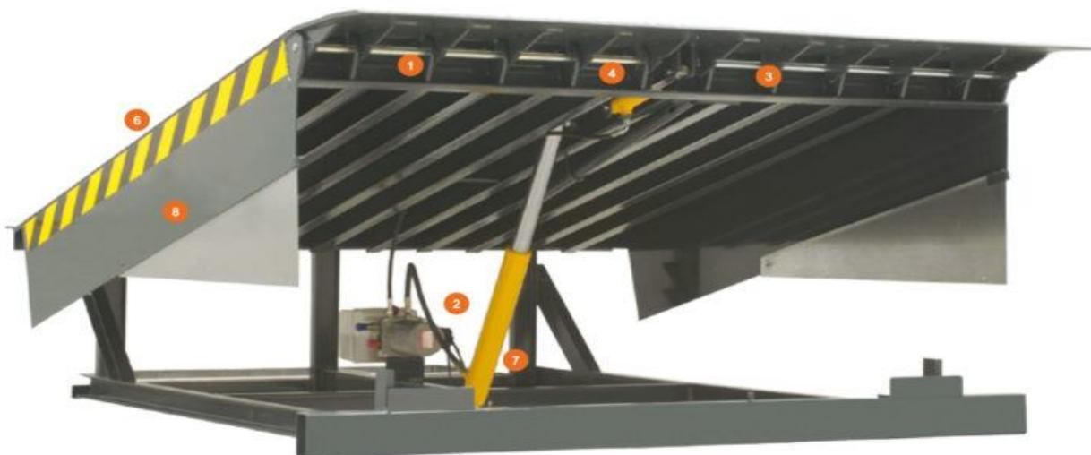
1 - Sistema de construção com dobradiças planas, auto-limpeza feitas com laser em aço para o alinhamento perfeito e resistência. O seu desenho evita que as partes dinâmicas da rampa se desapersem devido a problemas de sujidade.
